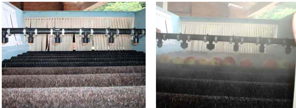
Figura 4.14. Protótipo de máquina classificadora com aspersores para o tratamento térmico e escovas de cerdas suaves e duras. Porto Alegre, Faculdade de Agronomia, UFRGS.
