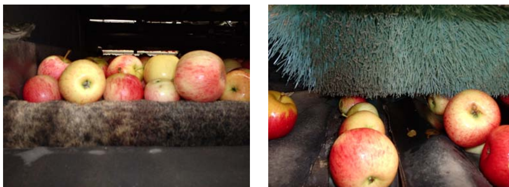
Figura 4.13. Escovação em máquina classificadora da empresa produtora e embaladora de maçãs Mercochem. Caxias do Sul, (Abril de 2006).
