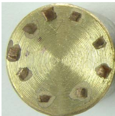
Figura 2.2. Suporte de alumínio (“stub”) com amostras de 1\text{mm}^2 de epicarpo de maçãs recobertas por uma camada de 15nm de ouro. Porto Alegre, 2006.
