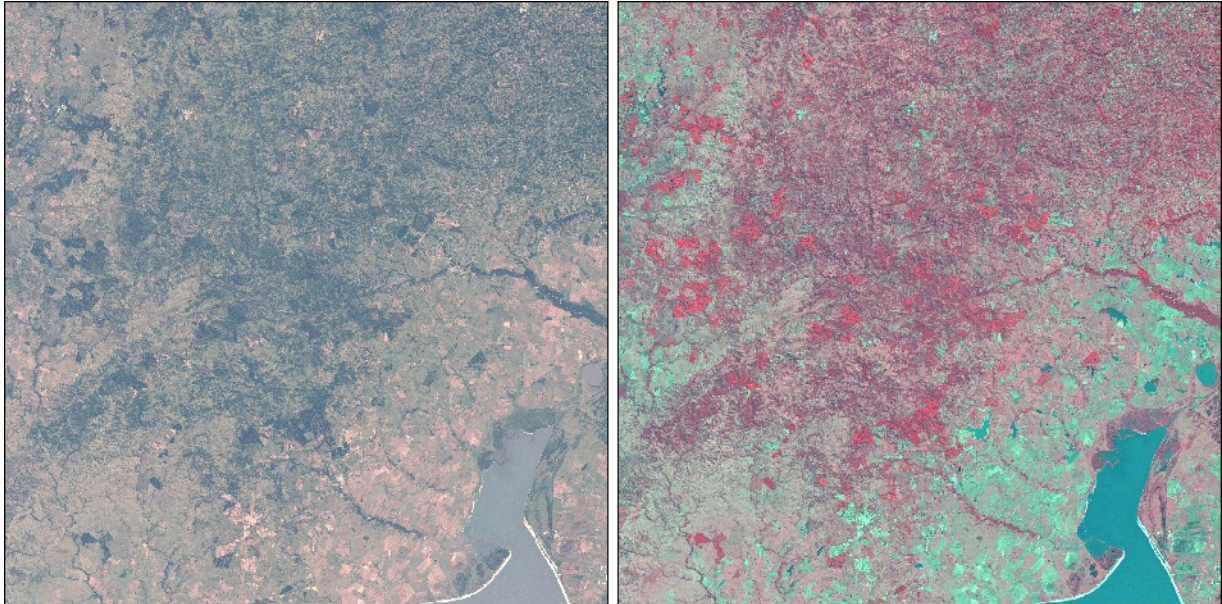
Figura 01 – Comparativo entre composição cor verdadeira (RGB 321), à esquerda, e falsa cor (RGB 432), à direita.
