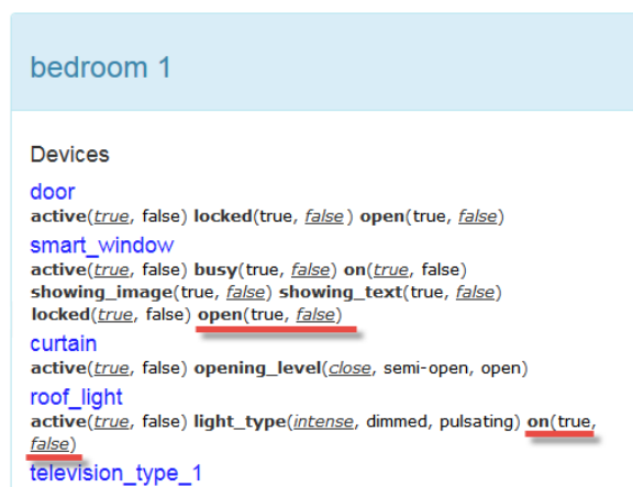
Figura 97 – Janela inteligente no estado fechado e a luz do teto no estado desligado
