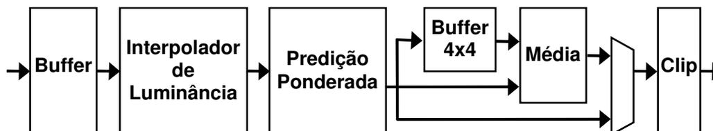
Figura 5.16: Arquitetura do processador de amostras de luminância
