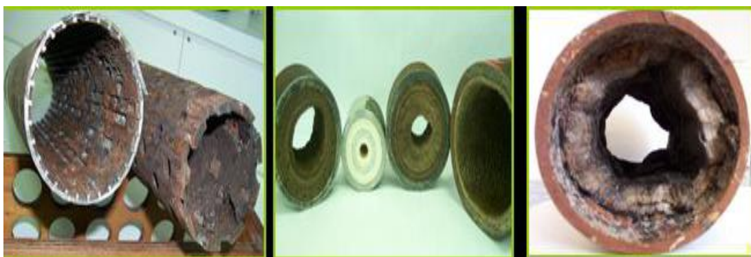
Figura 3. Exemplos de incrustações no sistema de produção de petróleo: A – tela de gravel pack, B – coluna de produção e C – linha de chegada na estação de tratamento do óleo.[7]
