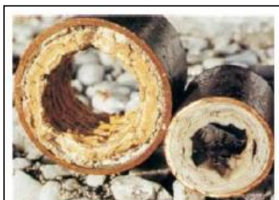
Figura 7. Incrustação de carbonato de cálcio em duto de produção. [7]
