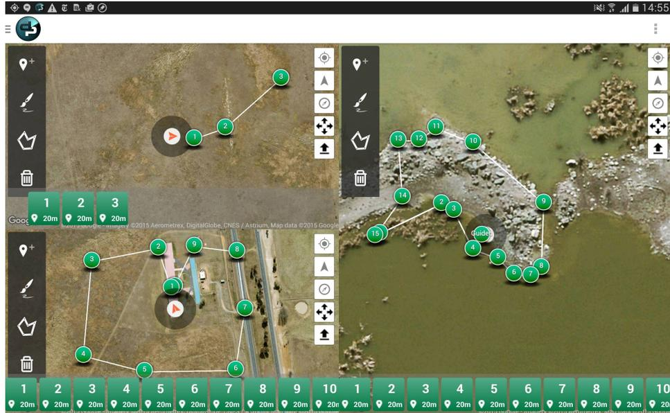
Figura 5.5 – Controle simultâneo de quatro VANTs
