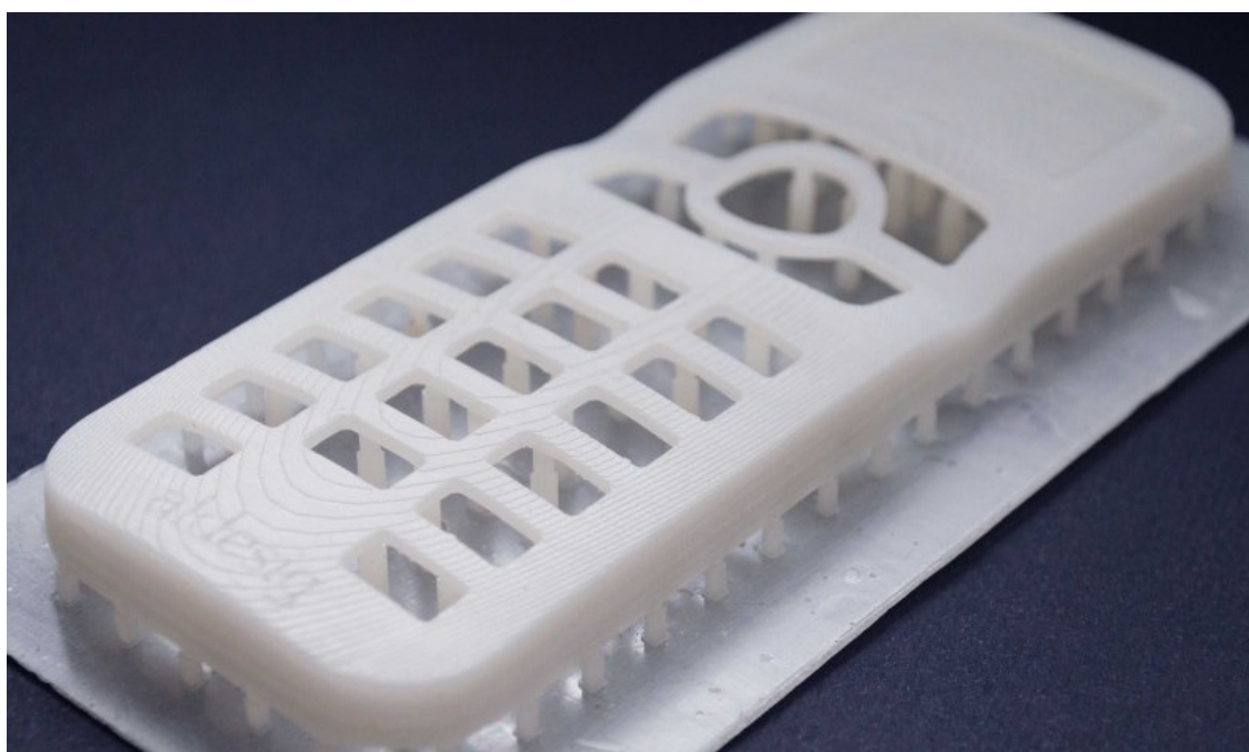
Figura 16: capa de telefone celular produzida por estereolitografia.
