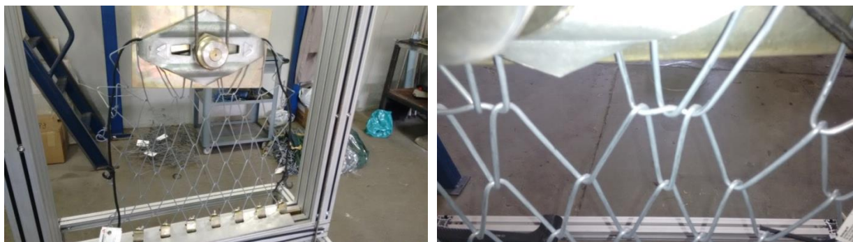
Figura 61: Detalhe do deslizamento dos arames nos pontos de contato.
