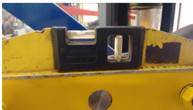
Figura 48: verificação do nível da viga de aplicação de carga. (fonte autor)
