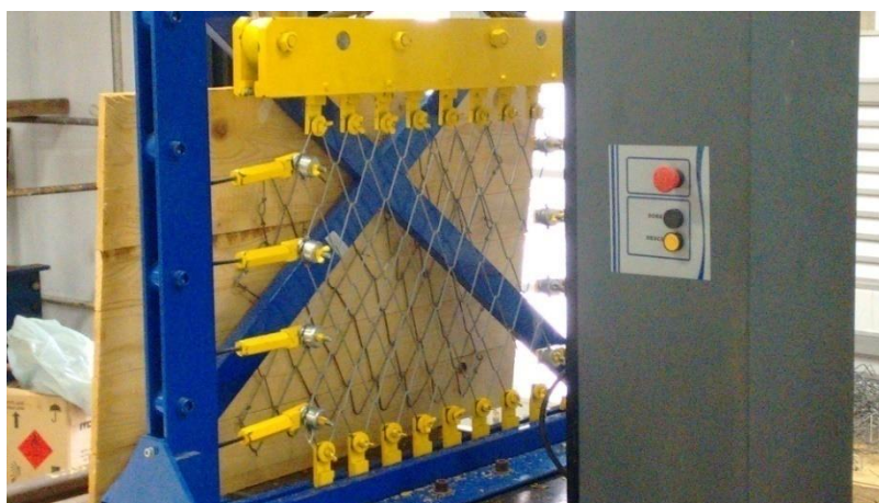
Figura 47: Esquema de fixação da tela junto ao pórtico de tração. (fonte autor)
