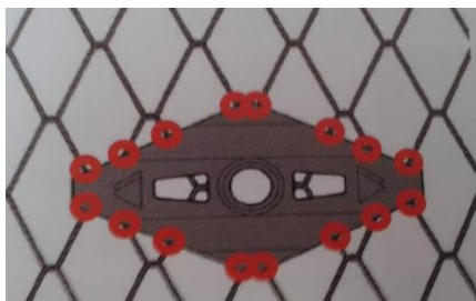
Figura 45: Formato da placa de fixação utilizada. Adaptado de Cala et al. (2012)
