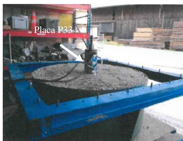
Figura 62: Arranjo da execução dos ensaios de puncionamento no solo fonte LGA (2014)
