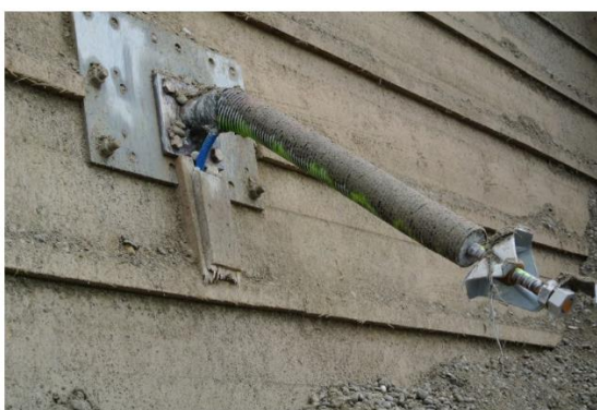
Figura 73: Flexão do grampo na região de ruptura do ensaio 01. Baraniak et al. (2014)
