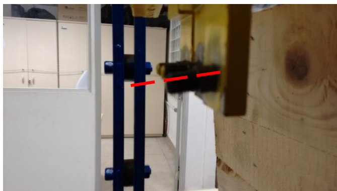
Figura 54: Parafuso que sofreu escoamento durante o ensaio 15.
