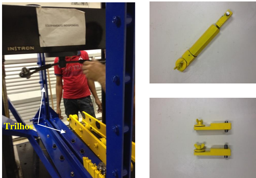
Figura 40: Detalhes das fixações laterais do pórtico. (fonte autor)
