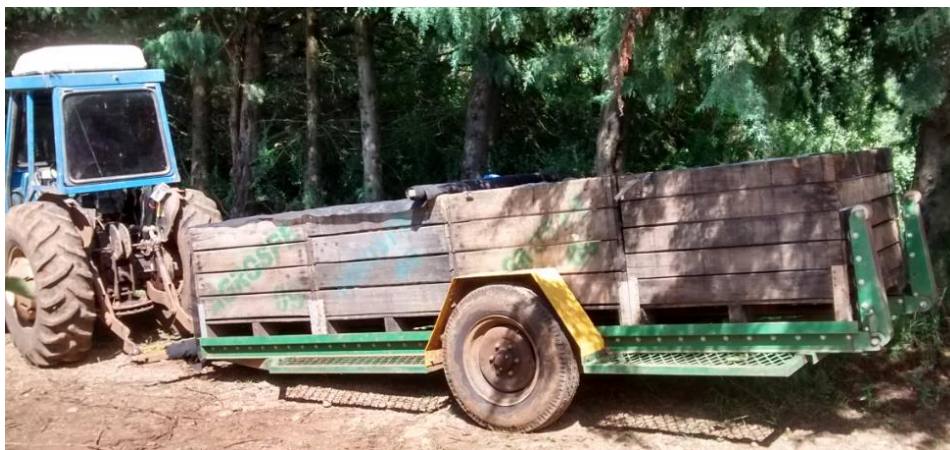
Figura 03 – Carrinho utilizado para carregamento dos bins no interior das linhas do pomar.
