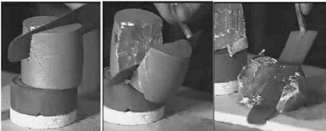
Figura 1.1: Sequência de fotos ilustrando o comportamento mecânico de uma liga metálica no ESS.
