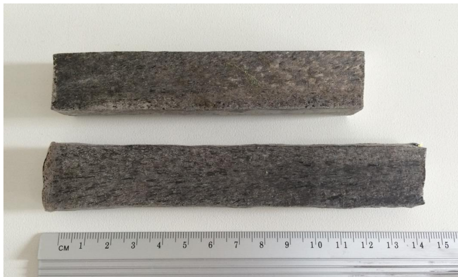
Figura 3.7: Corpos de prova após laminação a quente.
