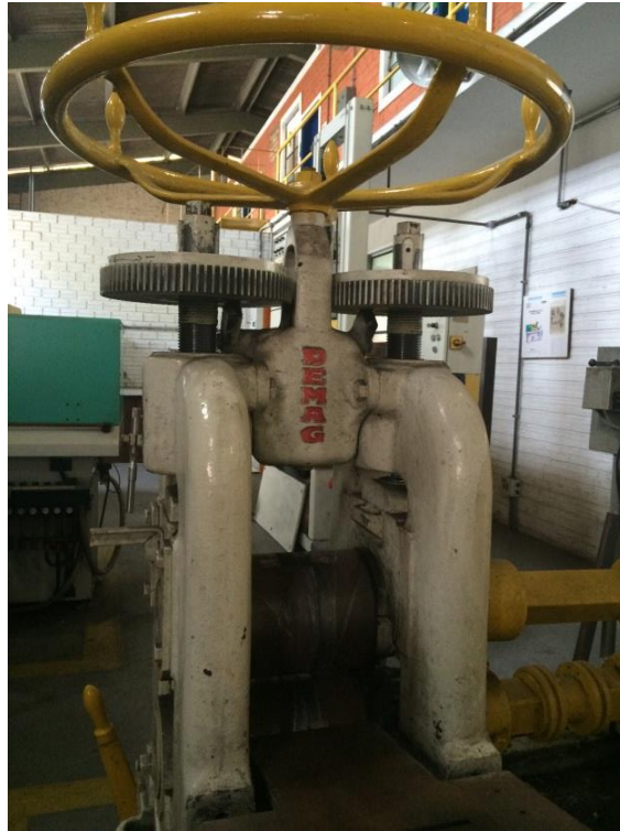
Figura 3.6: Laminador DEMAG utilizado na deformação.
