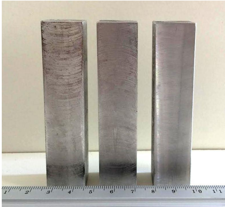
Figura 3.5: Corpos de prova após fusão e usinagem.
