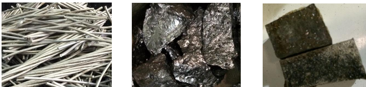
Figura 3.3: Alumínio, silício e magnésio, respectivamente, utilizados para confecção da liga.
