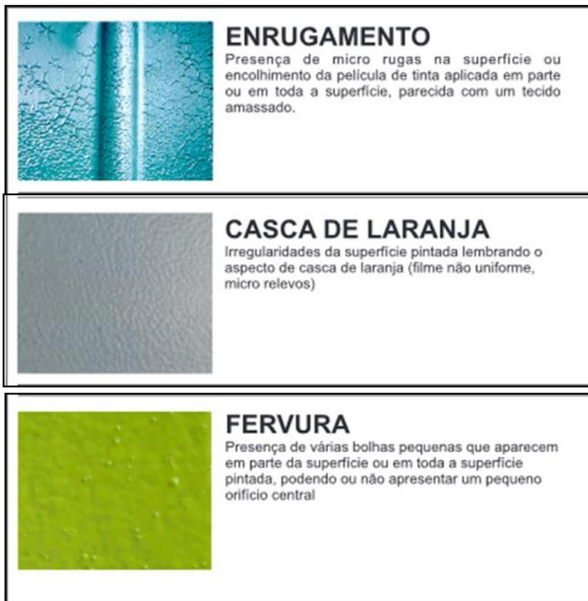
Figura 5.24 Diluição da Tinta com o Diluente não Recomendado – A figura ilustra três problemas frequentes que acontecem quando a tinta é diluída com um solvente muito volátil, ou que apresenta compatibilidade limitada com a resina. A escolha do solvente certo é imprescindível.
