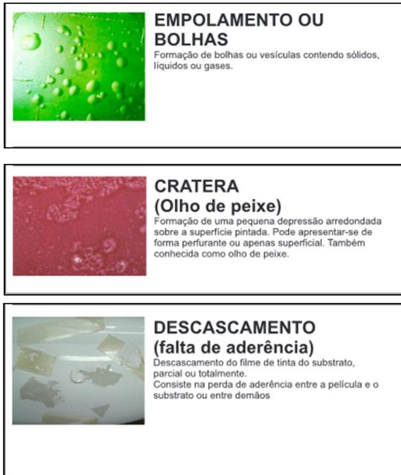
Figura 5.29– Superfície mal Preparada ou Oleosa - A figura ilustra três problemas frequentes que acontecem quando a superfície não é limpa adequadamente, apresentando partículas sólidas ou resíduo oleoso. A falta de aderência também pode ser causada por falta de lixamento, artifício utilizado para obter uma superfície rugosa.
