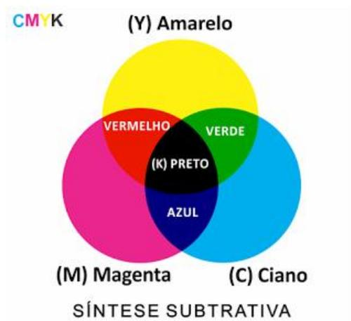
Figura 5.12- Sistema de Cores Subtrativo
