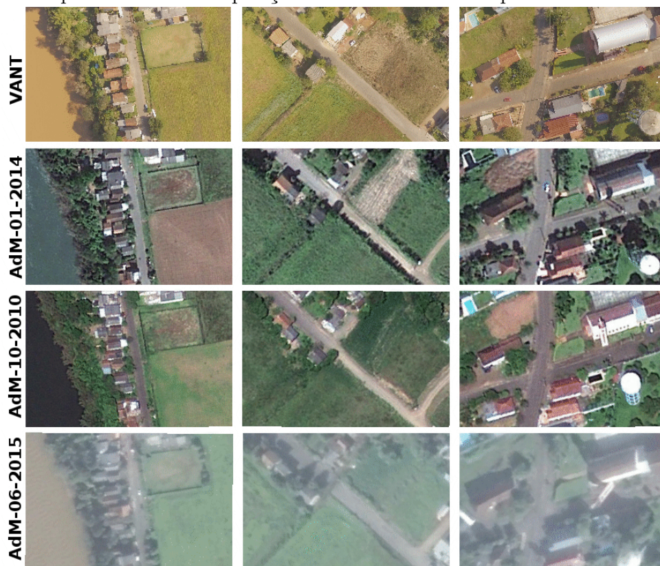
Figura 4.2: Exemplos de variações entre os mapas e a imagem capturada pelo VANT. A primeira linha mostra as imagens capturadas pelo VANT, enquanto que as outras linhas correspondem a mesma posição do robô em cada mapa.
