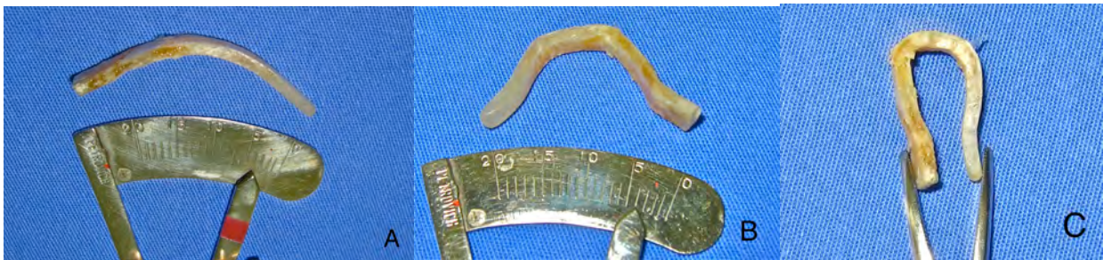
Fig 2: Mola, a esquerda aberta (A), ao centro moldada (B), a direita em compressão (C)
