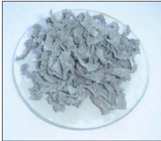
Figura 3.3: Serragem de rebaixadeira seco a 40°C em estufa por 24h.
