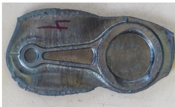
**Figura 20 – Biela Forjada - Amostra #4 (ensaio #7)**
