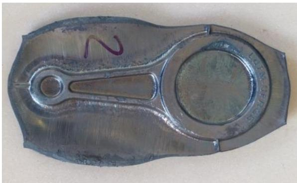
**Figura 18 – Biela forjada - Amostra #2 (ensaio #5)**
