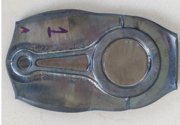
**Figura 17 – Biela forjada - Amostra #1 (ensaio #1)**
