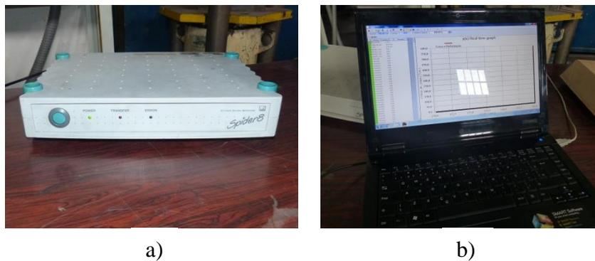
**Figura 11 – Equipamentos para aquisição de dados: a) HBM Spyder 8 b) Computador LG R48**
