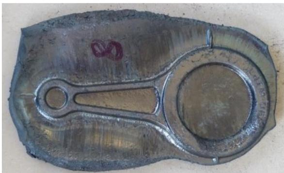
**Figura 24 – Biela Forjada - Amostra #8 (ensaio #8)**
