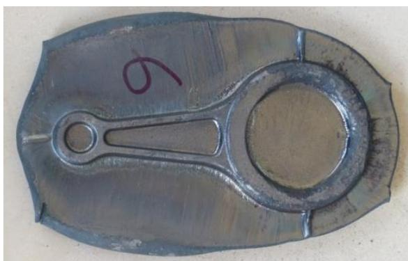
**Figura 22 – Biela Forjada - Amostra #6 (ensaio #6)**
