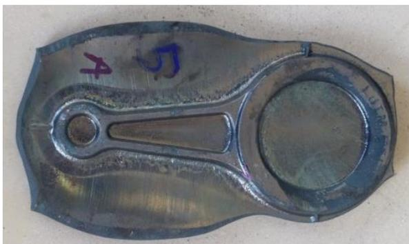
**Figura 21 – Biela Forjada - Amostra #5 (ensaio #4)**
