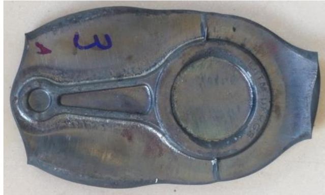
**Figura 19 – Biela Forjada - Amostra #3 (ensaio #2)**
