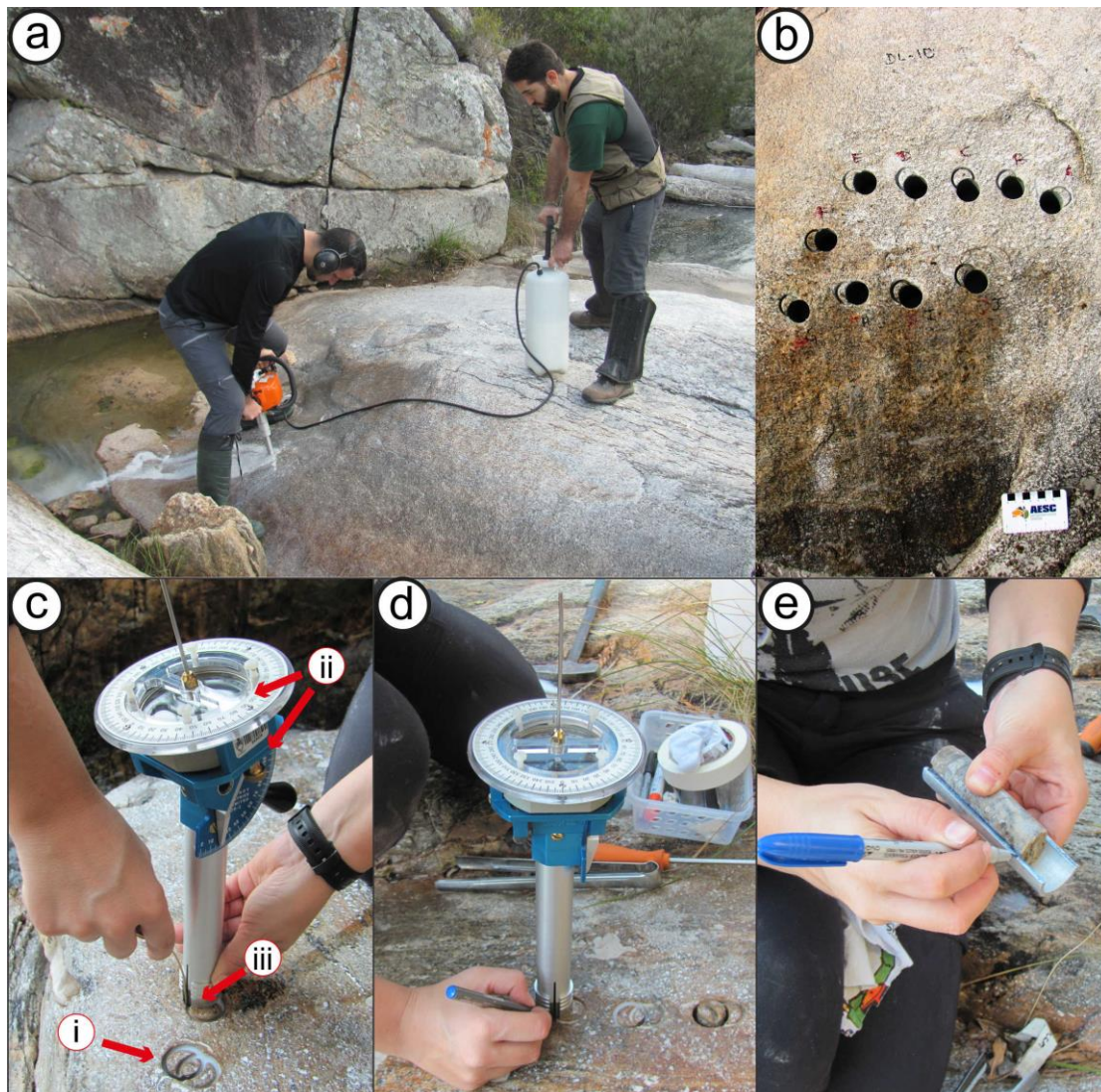
Figura 1 - Procedimento de amostragem: (a) perfuração realizada com perfuratriz manual com broca diamantada e sistema de arrefecimento/ lubrificação acoplado; (b) Furos realizados no sitio DL-10, note que cada furo tem uma marcação rente a ele, que serve como referencial; (c) marca de referência (i), orientador com clinômetro e bússola (ii) acoplado e processo de marcação com arame de cobre (iii); (d) orientação de furo cujo cilindro quebrou durante a perfuração; (e) transferindo o referencial geográfico para o cilindro após sua orientação.
