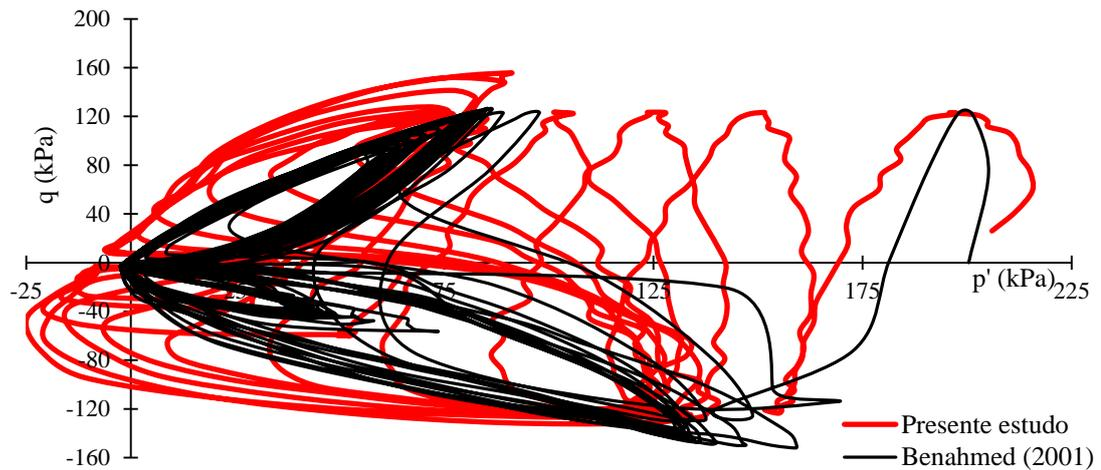
Figura 4.29: Sobreposição das trajetórias de carregamento obtidas para o ensaio TCRF 53 executado por Benahmed (2001) e o executado dentro do presente estudo.
