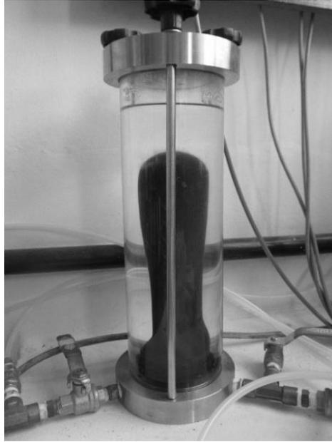
Figura 4.9: Interface Água – Ar para controle da pressão
