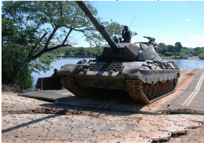
Figura 3. Veículo de combate Leopard 1A5 BR trafegando sobre as placas reforçadoras de solo.
