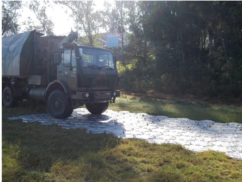
Figura 2. Viatura realizando teste nas placas reforçadoras de solo.
