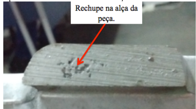
Figura 32. Indicação dos defeitos de fundição encontrados na placa reforçadora de solo. a) Trinca ao longo da nervura; b) Rechupe; c) e d) falta de preenchimento anterior a solidificação.
