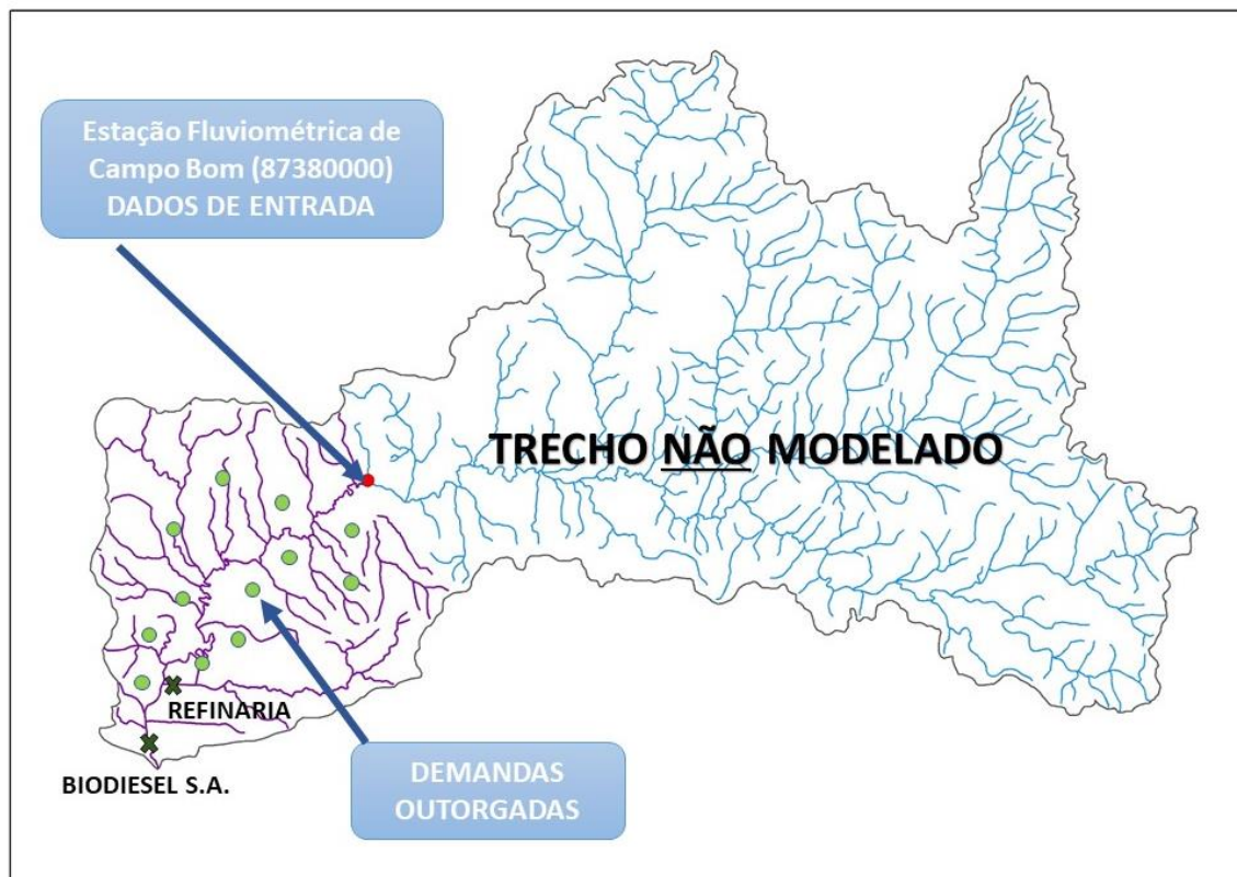
Figura 16. Bacia do Rio dos Sinos com a indicação da região modelada e não modelada, da estação fluviométrica, das indústrias estudadas e das demandas outorgadas.
