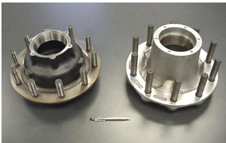
Figura 2.3 Cubo de roda originalmente fabricado em alumínio, com a fabricação com ADI apresentou redução de custo de 15% e redução de 0,5kg de massa.
