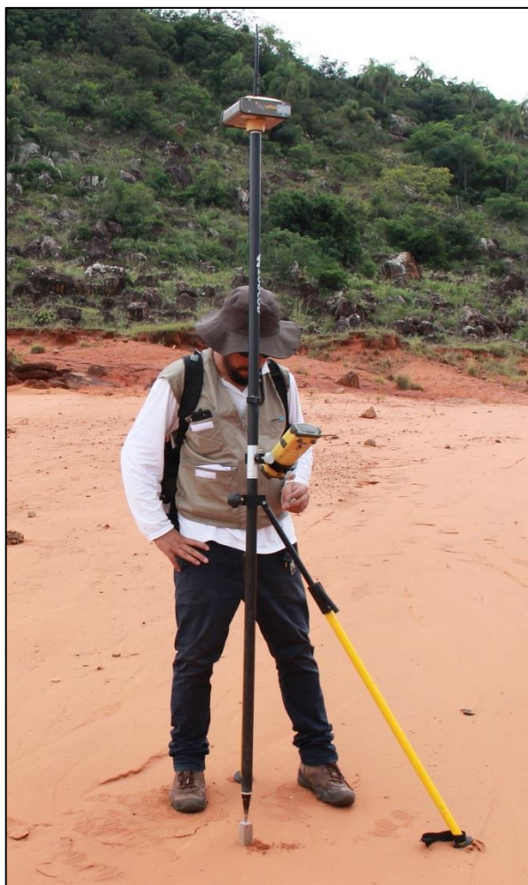
Figura 17 - Ocupação e rastreo de ponto de controle no quarto trabalho de campo. Foto do autor (Mar/2017).
