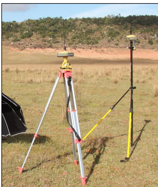
Figura 8 – Par de receptores GNSS Geodésico modelo Topcon Hiper Lite plus montados em um tripé com base nivelante e bipé e bastão de fibra de carbono. Foto do autor (Jun/2016).
