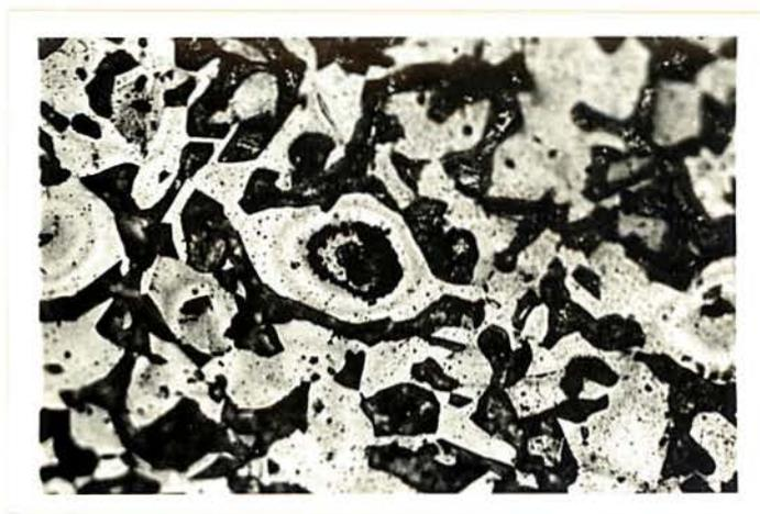
Figura 19 - Ataque semilocalizado na superfície do latão sem arsênio em cloreto arejado ao potencial de -200 mV (amostra 41).
