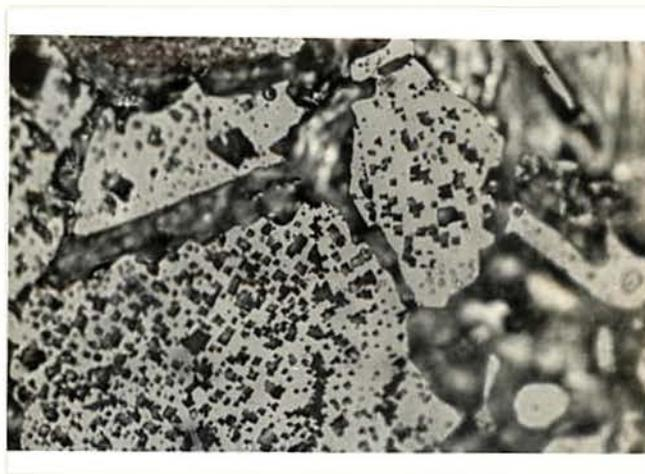
Figura 29 - Ataque intergranular e pites cristalográficos no latão sem arsênio em cloreto desarejado ao potencial de - 250 mV (amostra 52).
