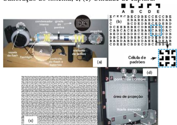
Fig. 12 – Sistema de reconstrução por luz estruturada: (a) Unidade de captura; (b) Codificação de Padrões; (c) Matriz de padrões codificados; (d) Placa de Calibração de Câmaras e do Projetor. Fonte: REISS (2007).
