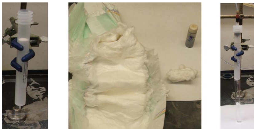
Figura 11. Filtração direta em coluna cromatográfica empregando polímero absorvente de água poliacrilato de sódio.
