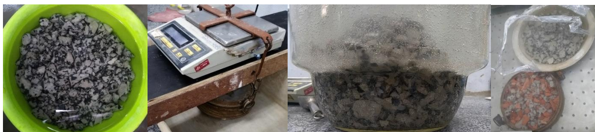
Figura 01 – Imagens dos ensaios realizados a)Ensaio NBR NM 53. b)Ensaio Leite. c)Ensaio Mills-Beale. d)Ensaio ASTM C642
