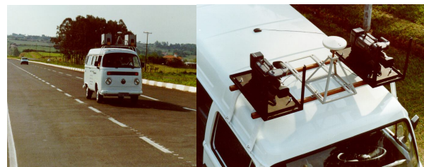
Fig. 4 – Composição UMMD desenvolvida na UNESP. Fonte: GUARDIA et al (1999).
