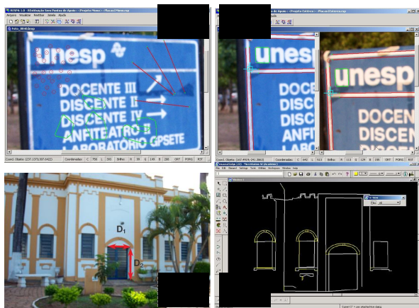
Fig. 10 – Medição com o sistema RESPA: (a) Programa RESPA em medição monoscópica; (b) RESPA em medição estéreo; (c) fachada do Museu Municipal de Presidente Prudente; (d) fachada medida com o programa RESPA.
