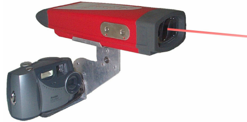
Fig. 9– CamDigTel: Integração Câmera Digital – Telêmetro
