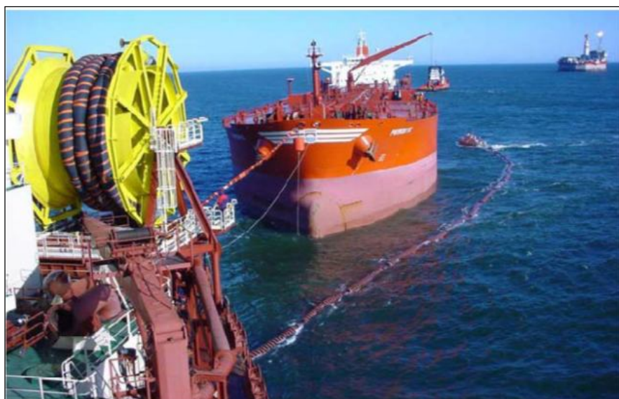
Figura 1: Preparação da linha de mangotes flutuantes para operação de offloading (COSTA, 2007).
