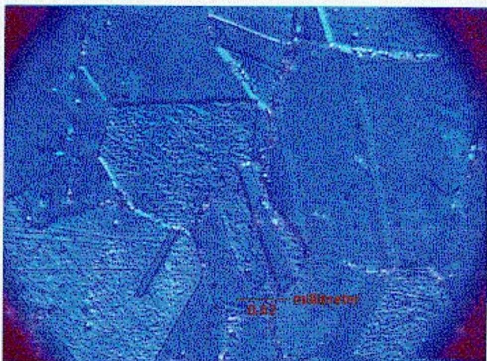
**Fig. 18 - Aço AISI 304 (aumento 500X - luz polarizada)**
