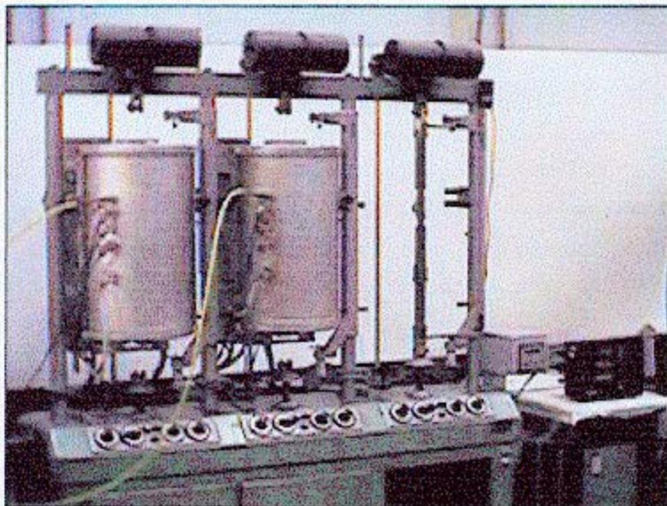
Fig. 22 - Máquina para ensaios de fluência.
