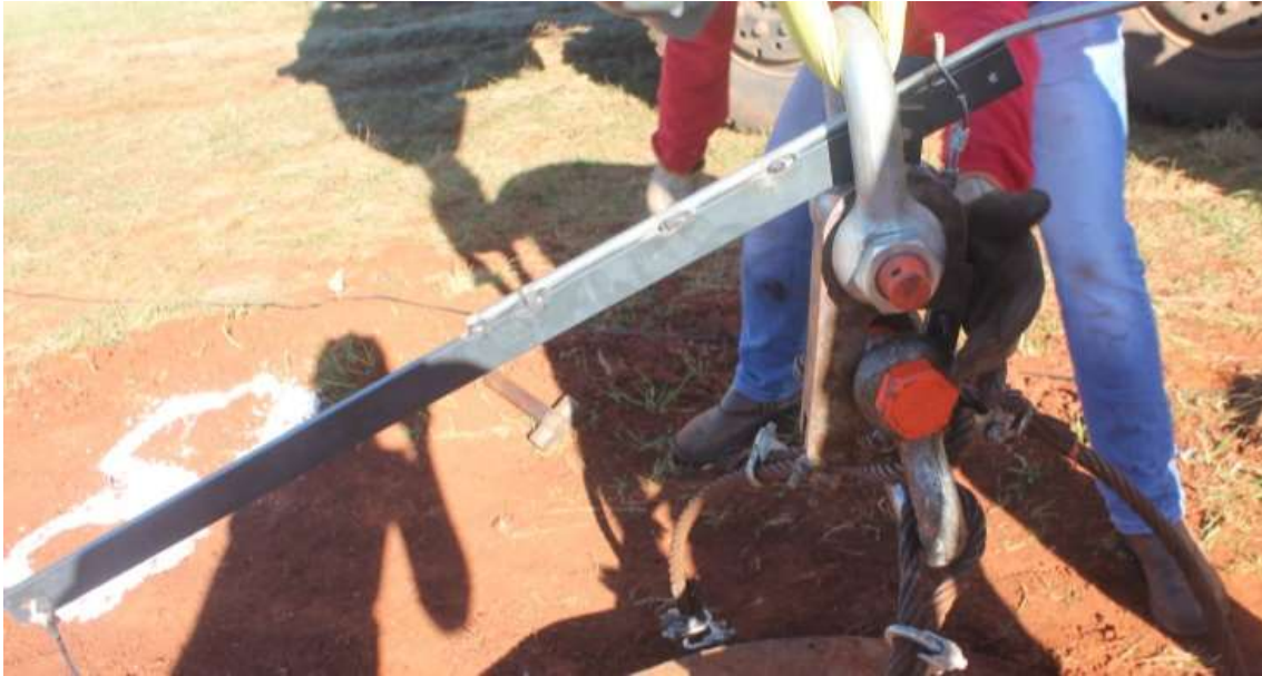
Figura 3.2: Gatilho com o acréscimo da alavanca na parte superior da peça
