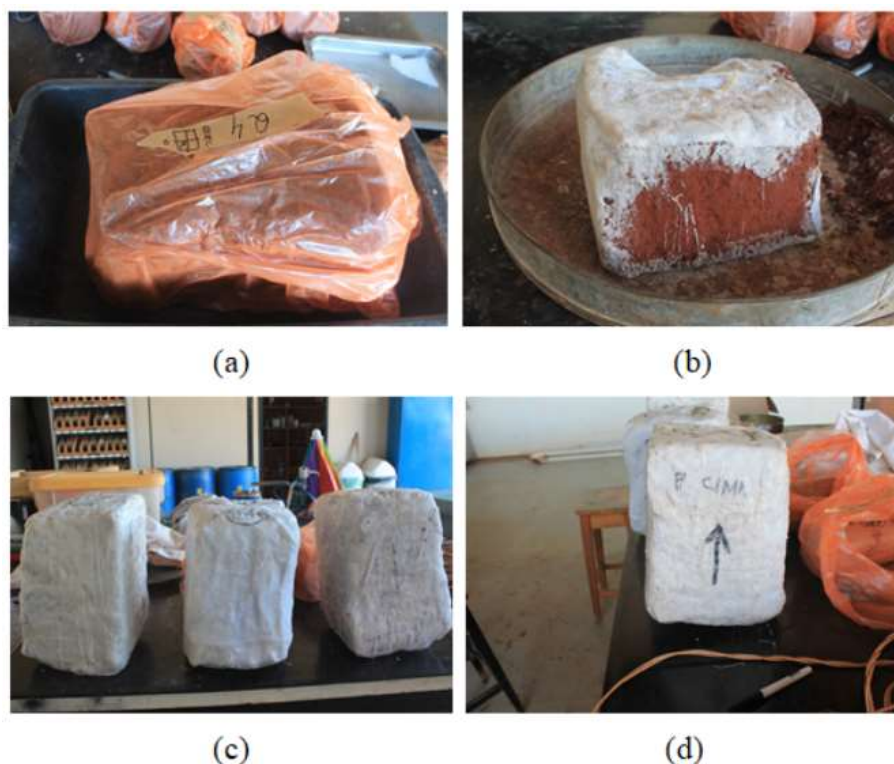
Figura 3.27 Processo de acondicionamento das amostras: (a) amostra retirada do campo; (b) aplicação de parafina; (c) amostras parafinadas; (d) detalhe da identificação
