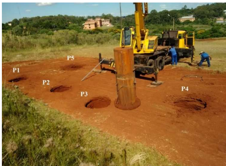
Figura 3.11: Detalhe dos pontos onde foram realizados os golpes no trabalho de Rizzon, 2016 (adaptado de Rizzon, 2016)
