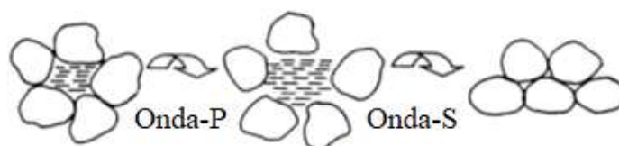
Figura 2.9: Esquema de ocorrência da densificação com a propagação da onda de choque durante a compactação dinâmica (adaptado de Hamidi, 2014)
