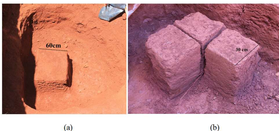
Figura 3.26: Detalhe da retirada das amostras indeformadas: (a) Bloco escavado dentro da cratera, com 60 cm de lado (b) Divisão do bloco principal em blocos menores
