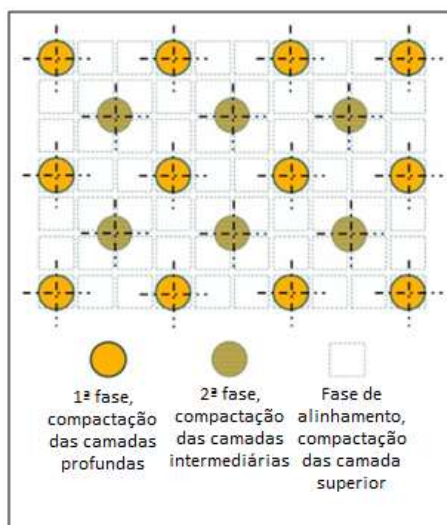
Figura 2.2: Detalhamento de múltiplas passadas na operação de compactação dinâmica (adaptado de MENARD GROUP, 2018)
