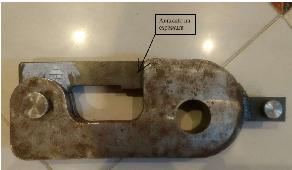
Figura 3.3: Gatilho com modificação na parte móvel, com maior resistência à flexão no “dente” da parte móvel
