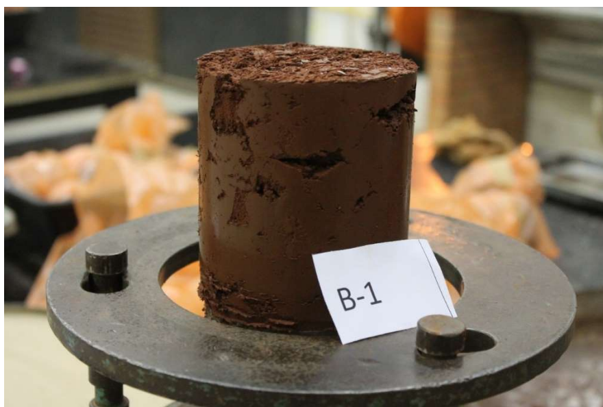
Figura 4.22: Amostra retirada da camada compactada com queda de 12,0 m
