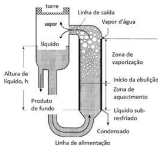
Figura 14: Desenho esquemático de um refervedor vertical termossifão (Fonte: adaptado pela autora de ARNETH e STICHLMAIR, 2001).
