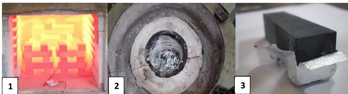
Figura 46 – Representação das etapas de tratamento térmico experimental de Austêmpera
