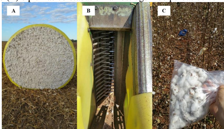
Figura 9 – Plumais de algodão prontos para serem transportadas para a algodoeira (A), detalhe do sistema de fusos, desfibradores e escovas da plataforma de uma colhedora de algodão (B) e plumas coletadas em amostragem de perdas de colheita (C).
