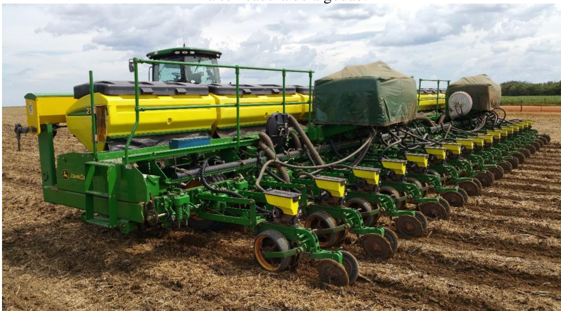
Figura 2 – Conjunto composto por Trator JD8230R + Semeadora JD2134CCS, utilizado na semeadura do algodão.
