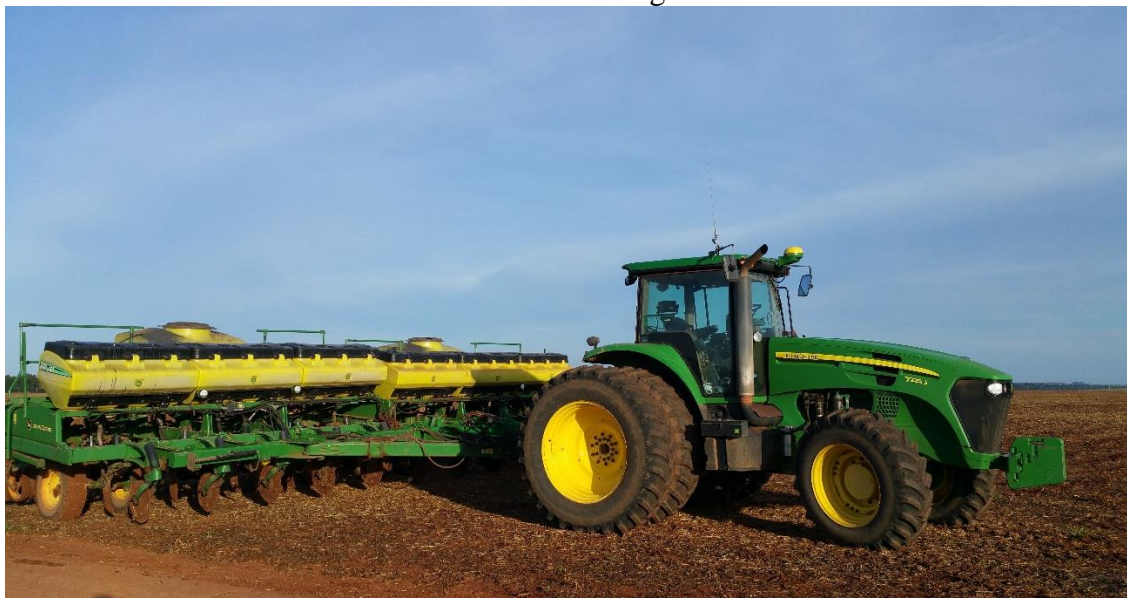
Figura 3 - Conjunto composto por Trator JD7225J + Semeadora JD2122CCS, utilizado na semeadura do algodão.
