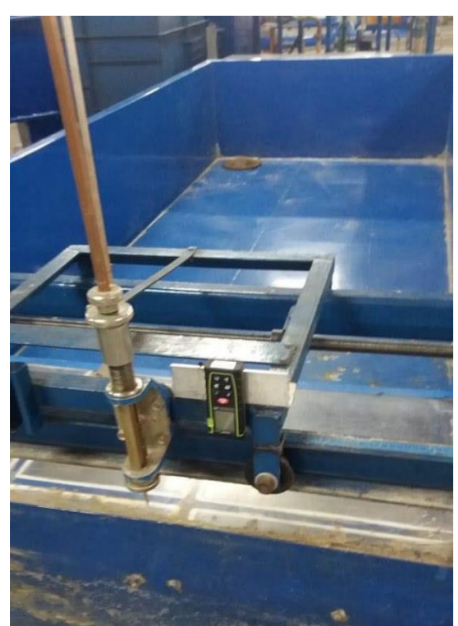
Figura 3 - trena a laser utilizada na batimetria da cava
