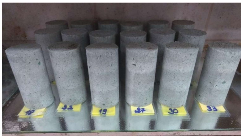
Figura 3.13: Corpos de prova acondicionados em câmara úmida
