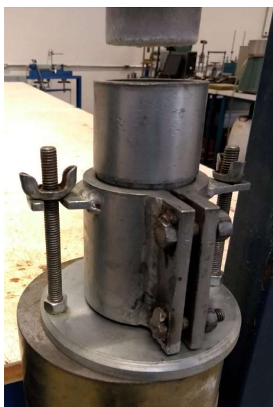
Figura 3.12: Molde tripartido de dimensões 5 cm de diâmetro e 10 cm de altura
