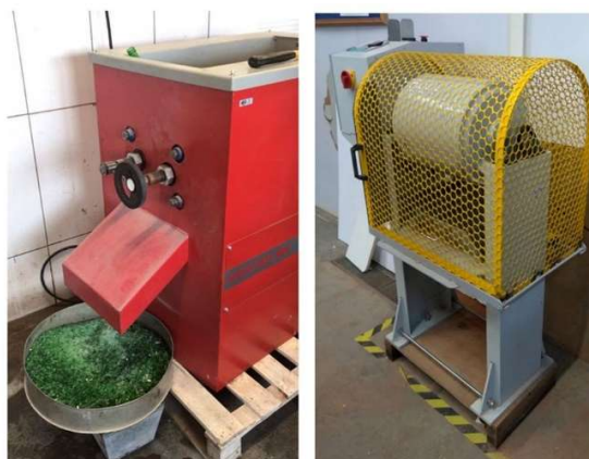
Figura 3.1: Equipamentos utilizados na moagem do vidro
