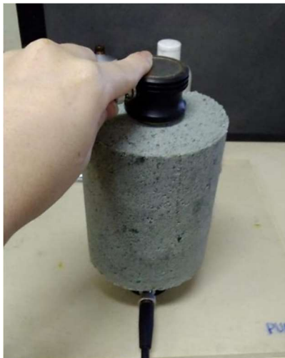
Figura 3.14: Execução do ensaio utilizando equipamento de ultrassom
