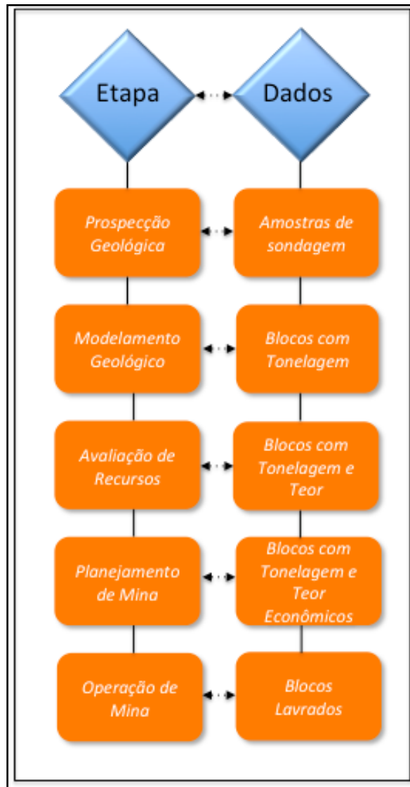
Figura 12 - Etapas do processo de mineração e suas respectivas gerações de dados.
