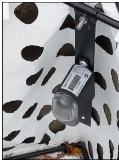
Figura 15 - Cesto Coletor com o Sensor Net Sensors.
