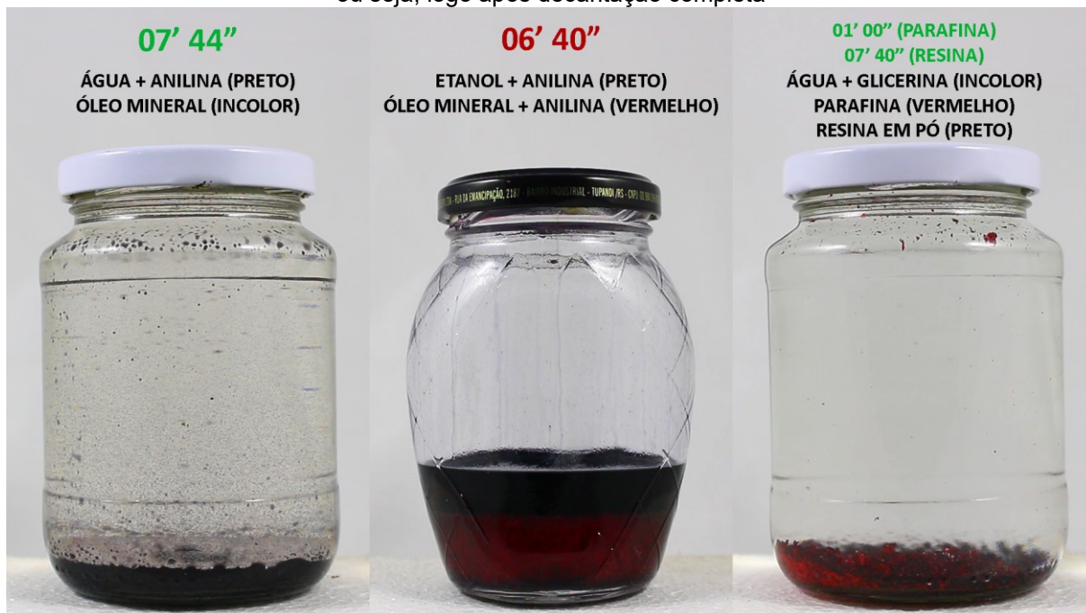
Figura 16 Possibilidades de mistura para fluido para “ Souvenirs from Brazil ” no instante final, ou seja, logo após decantação completa
