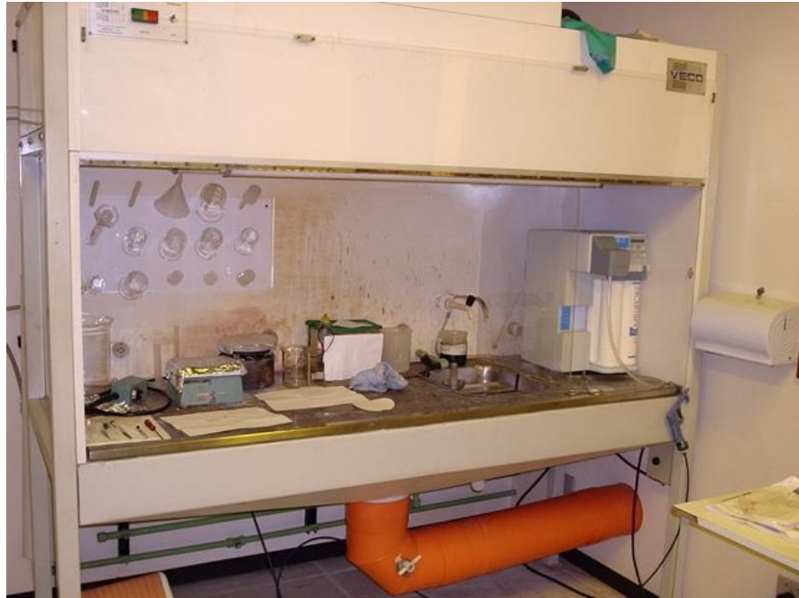
Figura 27 – Ambiente para realização da limpeza RCA na sala limpa da UFRGS. Obtida de ref. [37].
