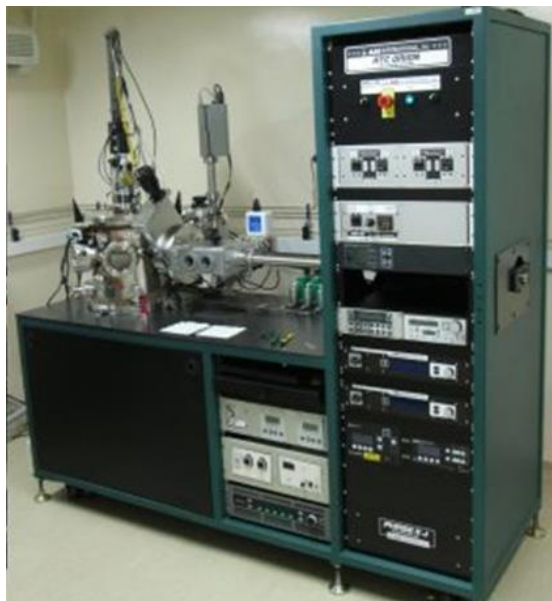
Figura 31 – Equipamento ATC Orion – 8 UHV da empresa AJA usado para deposição de filmes via sputtering.
