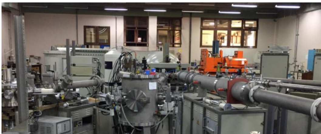
Figura 21 – Acelerador Tandetron de 3 MV presente no Laboratório de Implantação Iônica na UFRGS.
