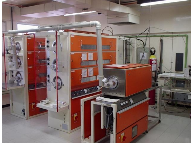
Figura 30. Forno para oxidação do Si, presente na sala limpa do laboratório de microeletrônica da UFRGS. Obtida de ref. [37].
