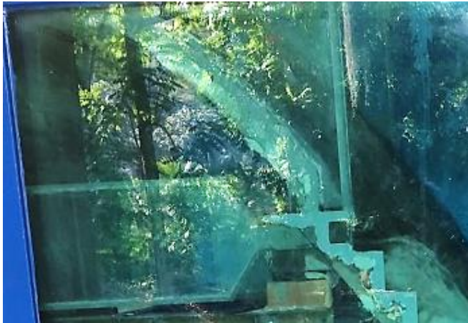
Figura 104 - sistema de indução de ar no modelo LAHE, (a) foto e (b) esquema
