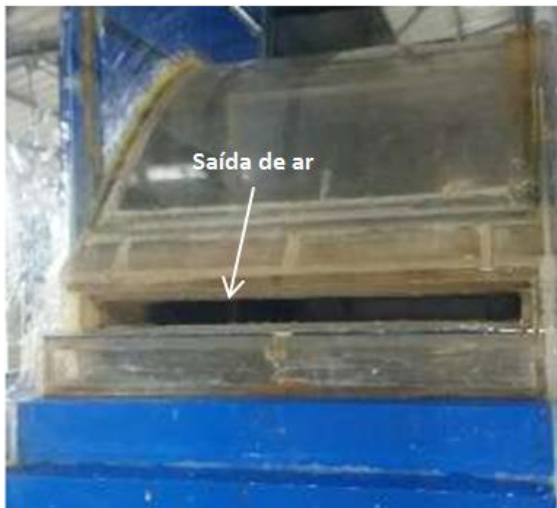
Figura 116 – foto da abertura no espelho do degrau para fornecimento de ar no modelo LOH II.
