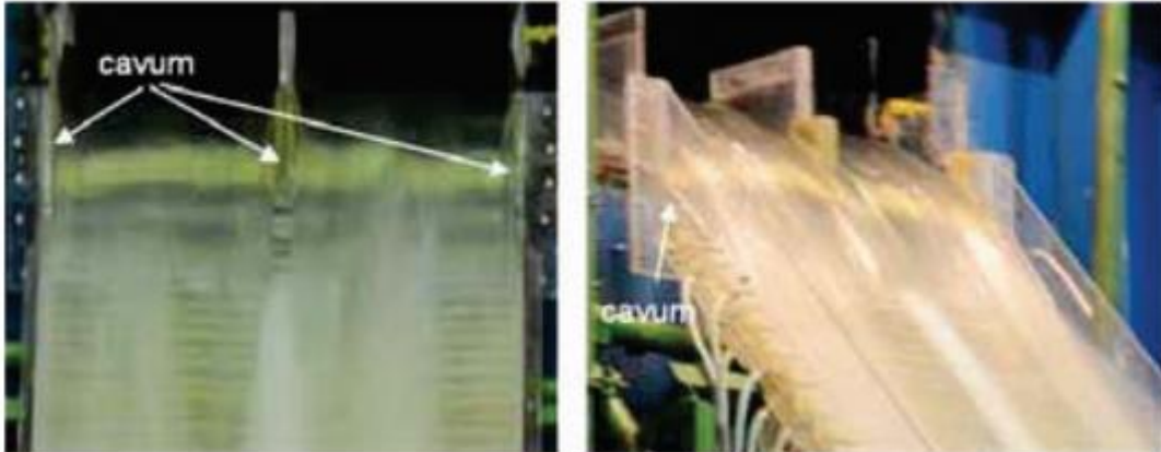
Figura 30 – Modelo de vertedouro em degraus com aeração induzida estudado por Wang et al. (2012). (fonte: Wang et al., 2012)
