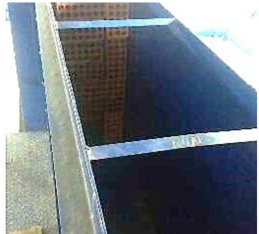
Figura 112 – Tranquilização do escoamento no modelo LOH I.
