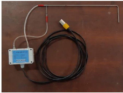
Figura 153 – Tubo de Pitot Prandtl com transmissor de pressão
