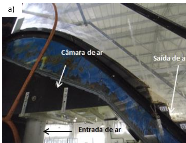
Figura 110 – Sistema de indução de ar no modelo LOH I, (a) foto e (b) esquema.
