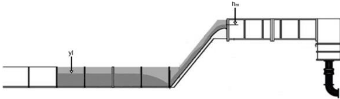
Figura 59 – Alturas de lâminas d'água medidas no modelo LOH I para análise da dissipação de energia.
