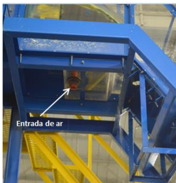
Figura 115 – Foto e esquema do sistema de indução de ar no modelo LOH II.
