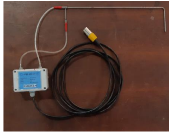
Figura 51 – Tubo de Pitot Prandtl com transmissor de pressão
