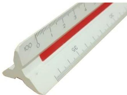
Pode-se observar a Figura 3 para melhor compreensão do assunto. Suponha que a planta baixa esteja representada na escala 1/50. Com o uso do escalímetro poderemos ver que a dimensão da parede medida pelo escalímetro é de 2 metros.
