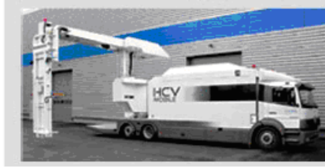
Figura 4: caminhão-scanner montado para uso.
