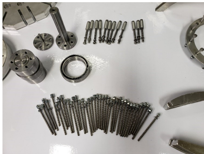
Figura 94 – Peças que foram usinadas para o suporte dos módulos e estrutura mecânica do protótipo.
