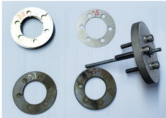
Figura 98 – Arruelas de ajuste e ferramenta de ajuste dos pinos centralizadores dos rotores.
