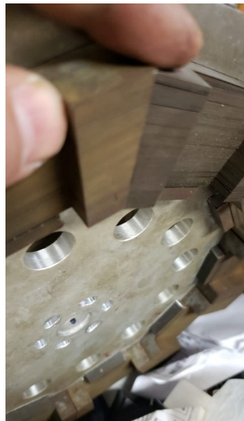
Figura 96 – Polos do rotor montados na culatra mecânica de alumínio liga 5052.
