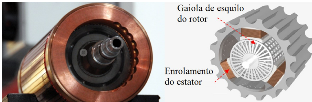
Figura 18 – Máquina de indução, (a) Rotor de gaiola cobreada que equipa o motor do Tesla Roadster, (b) Esboço simplificado dos componentes de um MI.
