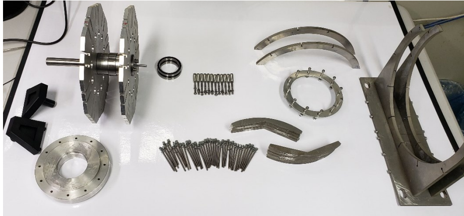
Figura 93 – Peças que foram usinadas para o suporte dos módulos e estrutura mecânica do protótipo.
