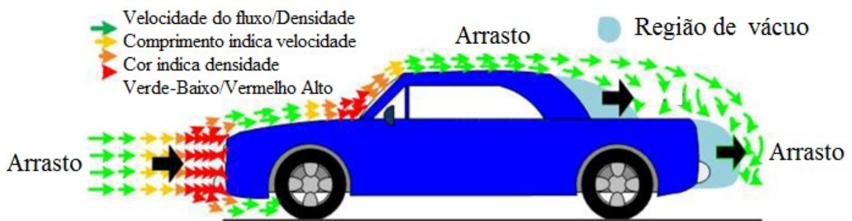
Figura 13 – Representação do comportamento do arrasto aerodinâmico em uma carroceria.
