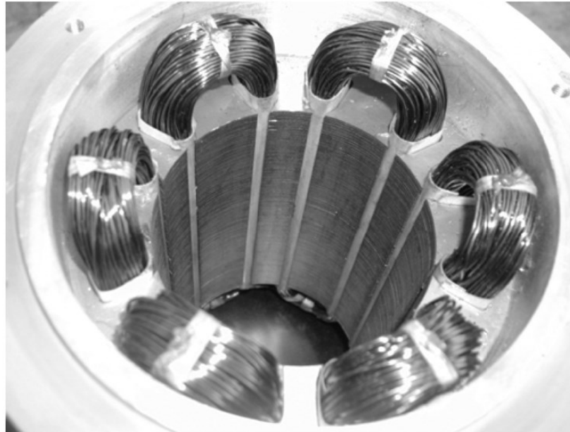
Figura 22 – Máquina de relutância chaveada de múltiplos dentes 12S/8P com enrolamento concentrado de camada simples.
