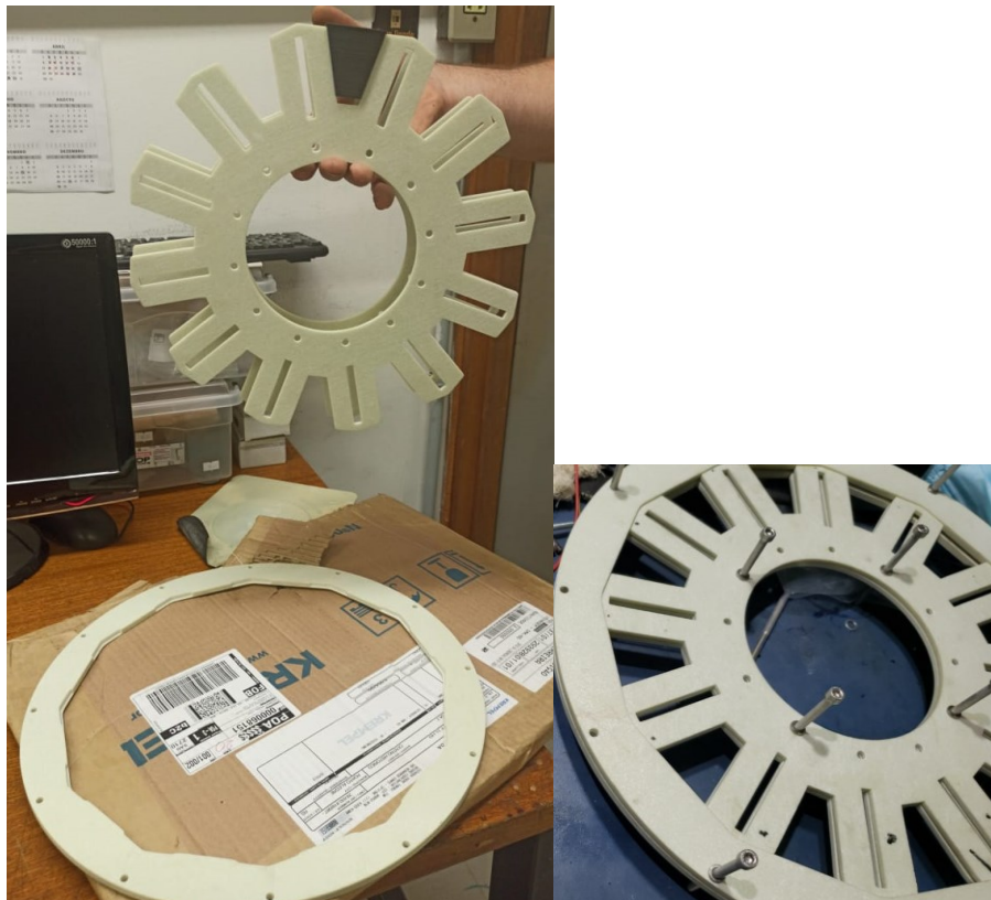
Figura 89 – Material DMK65 finalizado para construção do estator (material não condutor e não ferromagnético).
