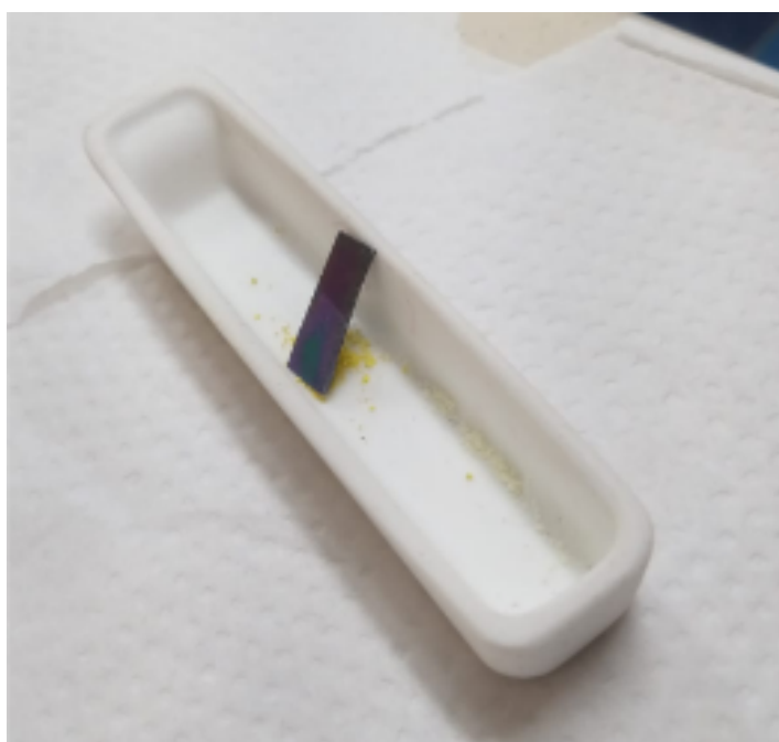
Figura 10: arranjo experimental do substrato em cima do cadinho
