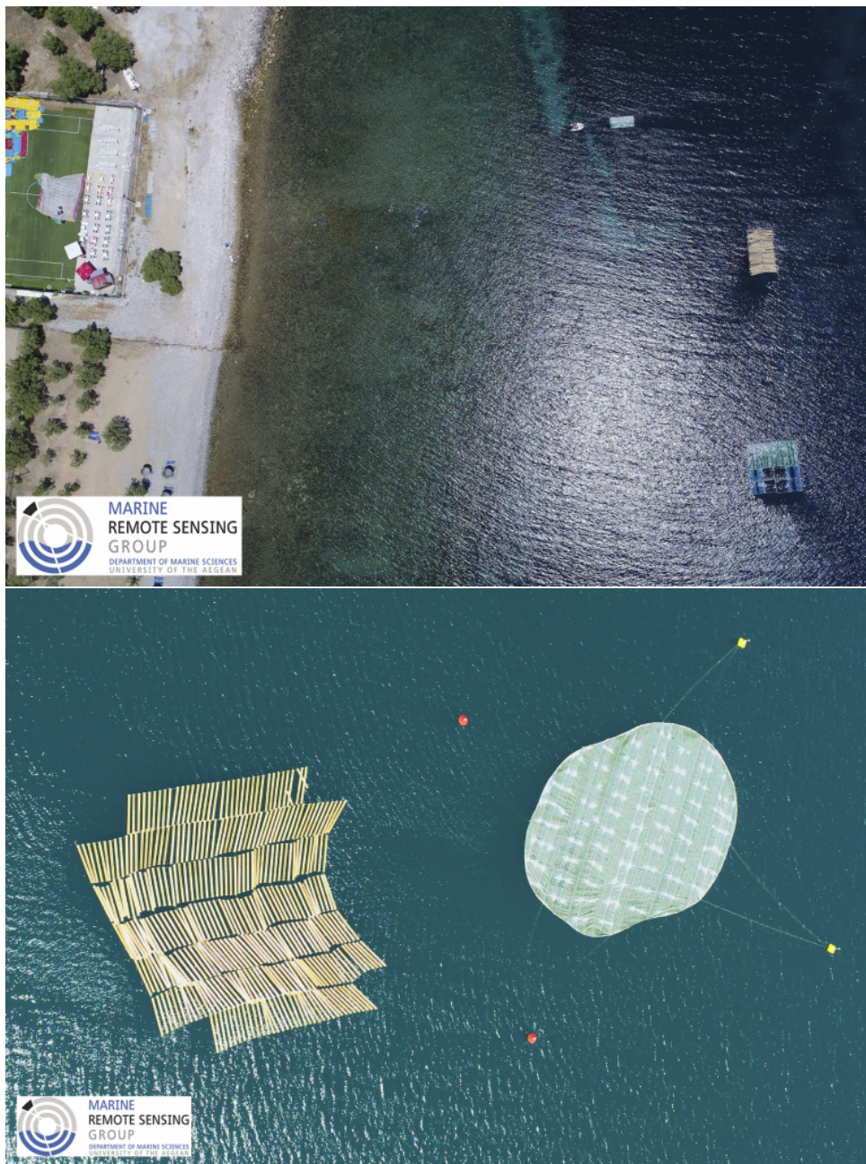
Figura 18 – Alvos artificiais implantados na Grécia durante os PLPs 2019 (superior) e 2021 (inferior) em fotografias aéreas adquiridas por VANT.
