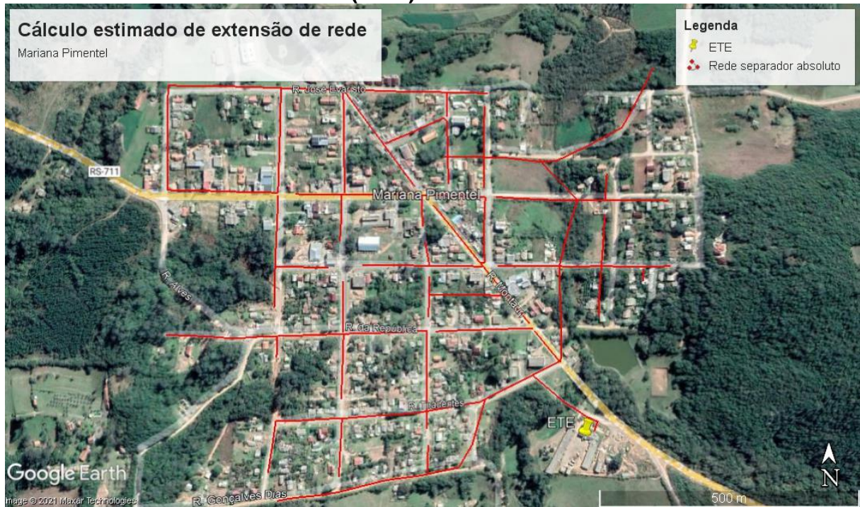
Figura 19: Cálculo estimado de extensão de rede com base em planta de SES da CONCREMAT (2005).
