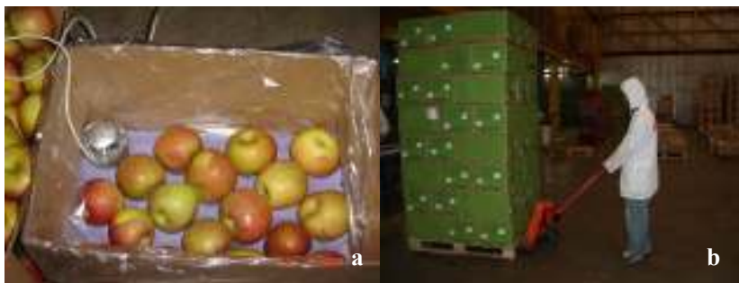
FIGURA 3. Posicionamento da esfera instrumentada na caixa de maçãs na instalação dos ensaios (a) e imagem de um palete de 8 camadas de caixas tipo internacional (b). Vacaria, 2007.
