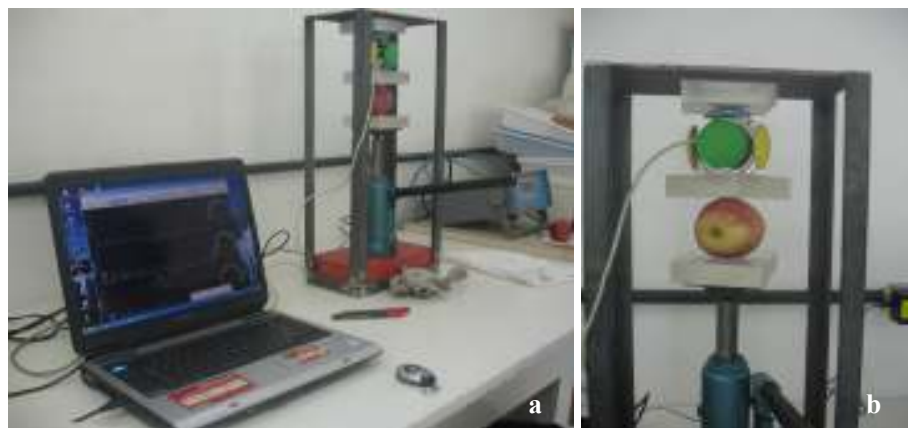
FIGURA 4. Sistema de aplicação de compressões constituído por um levante hidráulico, duas placas acrílicas e a esfera instrumentada conectada a um computador (a) detalhe da aplicação do tratamento em uma maçã (b). Porto Alegre, 2008.
