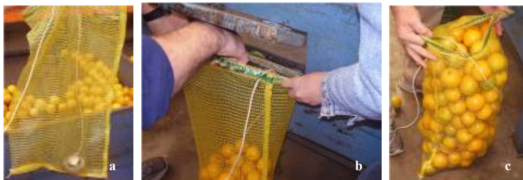
FIGURA 11. Posicionamento da esfera instrumentada na sacola (a), enchimento da sacola (20 Kg) de laranjas (b), procedimento de ajuste final da sacola antes do fechamento (c). São Sebastião do Caí, 2007.
