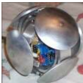
FIGURA 1. Esfera instrumentada com três anéis concêntricos instrumentados e com extensômetros capazes de detectar forças em três eixos ortogonais. Fonte: Müller e Bender. Porto Alegre, 2006.
