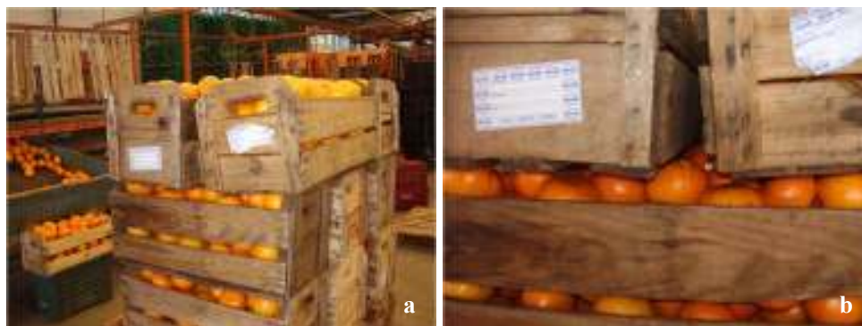
FIGURA 16. Empilhamento de caixas de laranjas de 15 Kg (a), caixas desencontradas (b). São Sebastião do Caí, 2007.
