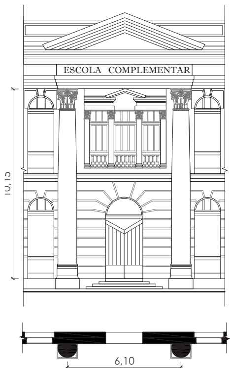
Figura 112- Redesenho com as proporções do pórtico de entrada.
