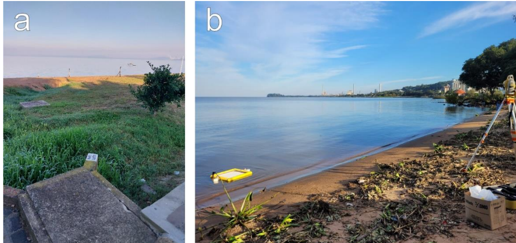
Figura 52 – Campanhas de levantamento executados em Ipanema (a), onde foram realizadas as medidas diretamente na régua linimétrica e Guaíba (b), onde foi usado o dispositivo flutuador.
