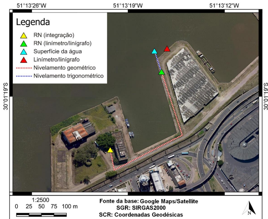
Figura 34 – Simulação de uso de métodos terrestres de nivelamento para a integração de referenciais altimétricos (nivelamento híbrido parcial).
