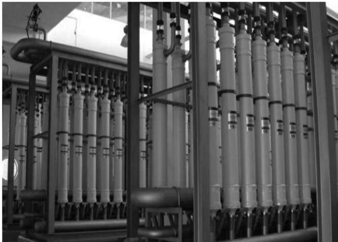
Figura 12: sistema de ultrafiltração convencional
