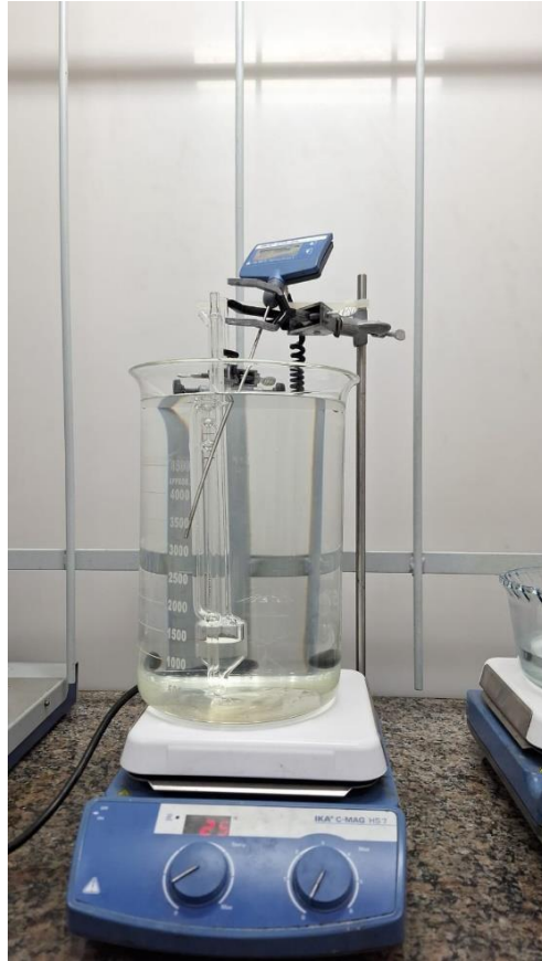
Figura 24 -Sistema empregado para determinação da viscosidade intrínseca. Elaborado pelo autor, 2023.
