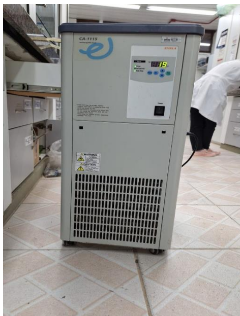
Figura 22- Chiller empregado para recirculação de água no condensador de refluxo. Elaborado pelo autor, 2023.
